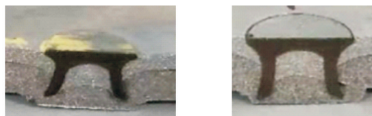
(a) G100110铆接互锁值 L_L=0.51\text{ mm} , L_R=0.53\text{ mm} , T_{\min}=1.01\text{ mm} (b) G115130铆接互锁值 L_L=0.48\text{ mm} , L_R=0.38\text{ mm} , T_{\min}=0.43\text{ mm}
