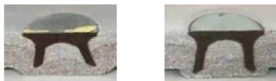
(a)长度为4 mm铆钉互锁值 L_L=0.36\text{ mm} , L_R=0.38\text{ mm} , T_{\min}=1.3\text{ mm} (b)长度为5 mm铆钉互锁值 L_L=0.42\text{ mm} , L_R=0.41\text{ mm} , T_{\min}=0.2\text{ mm}
