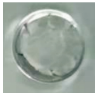
图3 自冲铆接铆点底部裂纹形貌
